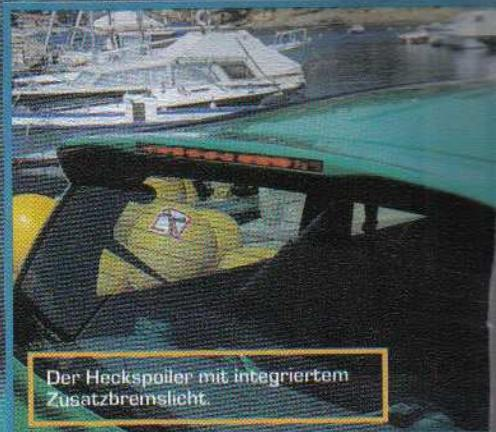
Der Heckspoiler mit integriertem Zusatzbremslicht.
