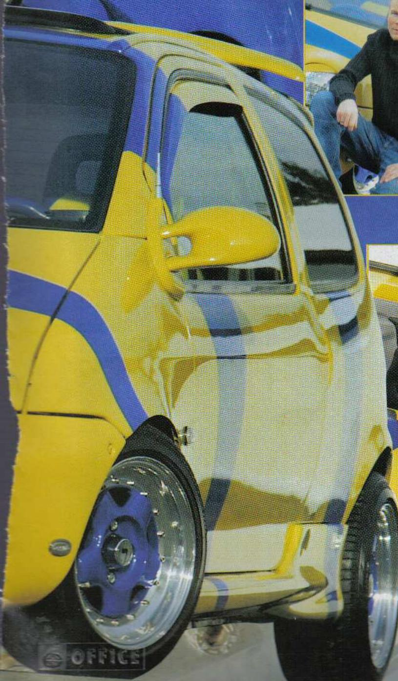
an! Eine geänderte RS-Front, Seitenschweller und ein geändertes Heck lassen den Renault noch einen Tick sportlicher erscheinen. Ansonsten findet man noch eine Elia-Lufthutze, M-Look-Spiegel, Scheinwerferblenden sowie einem genialern Eigenbau-Dachspoiler, der bei zügiger Fahrt für den nötigen Abtrieb sorgt.
