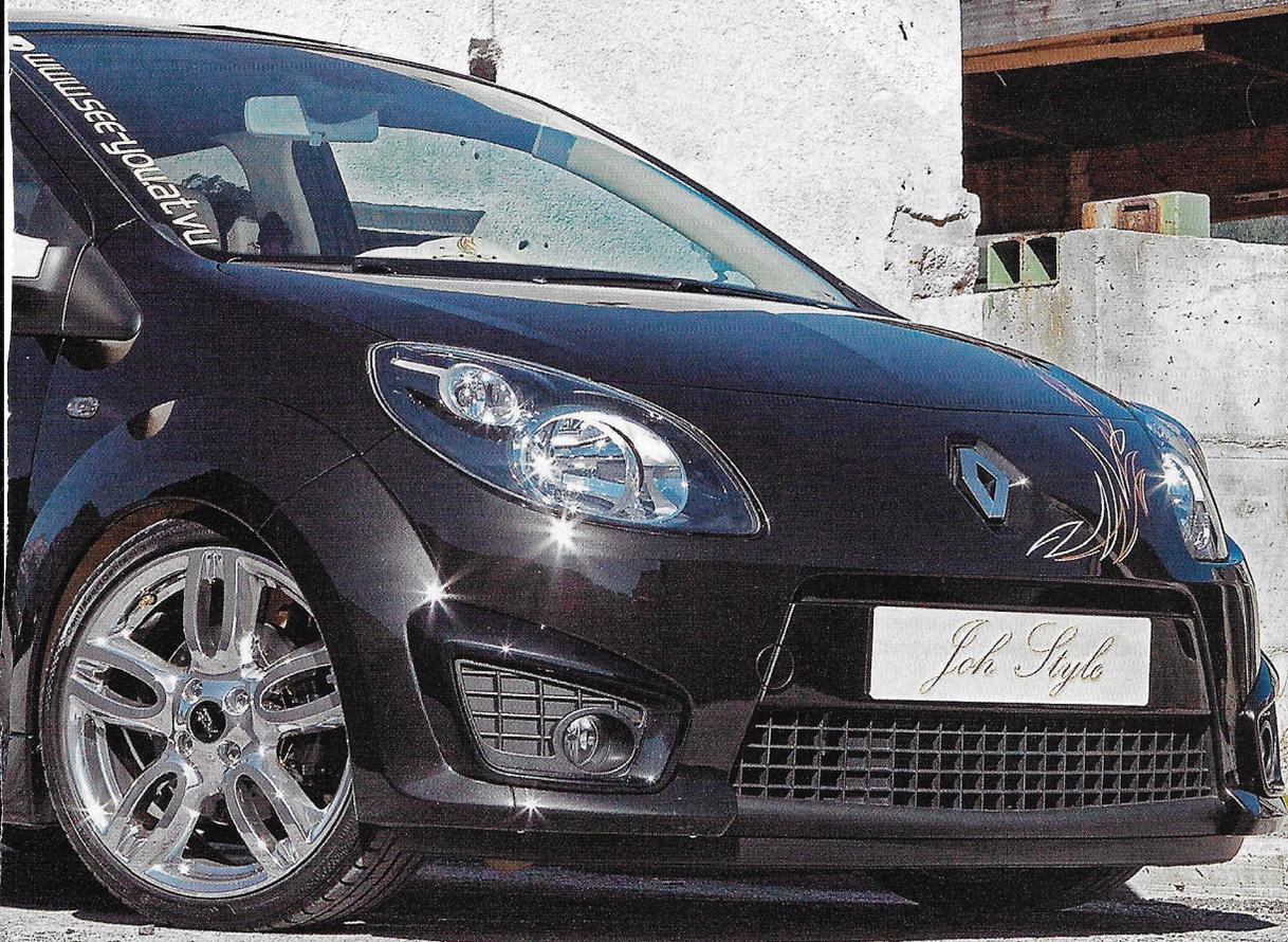
Das KW-Gewindefahrwerk senkt die Karosserie vorne und hinten um 70 Millimeter ab, was den Blick auf die beigefarben lackierte Hinterachse erschwert
